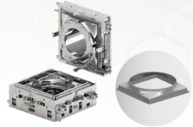
Cage ventilation fan mold
