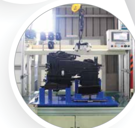
Bàn hoàn thiện bộ gia nhiệt HVAC assembly table
