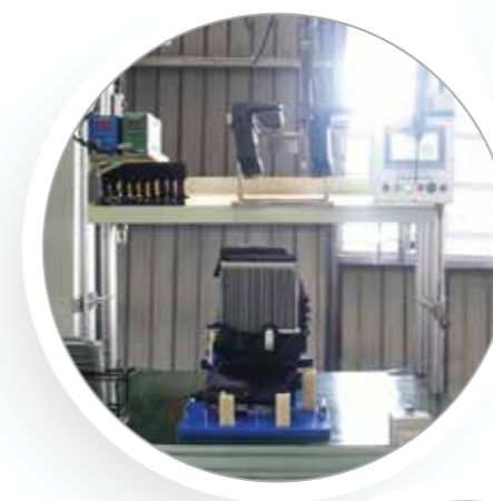
Bàn lắp ráp dàn lạnh và bộ sưởi Evap - HTR assembly table
