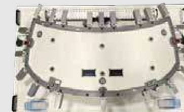
Thiết kế và sản xuất khuôn uốn và đường kiểm tra kính Design and process glass bending mold, glass inspection jig
