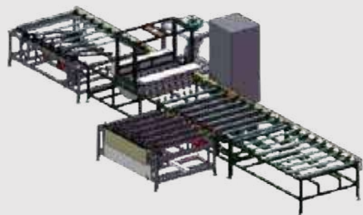
Máy kiểm tra đứt dây và điện trở lưới sợi Photoresistive glass inspection system
