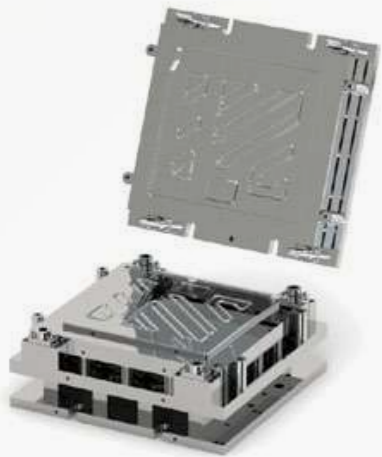
Khuôn dập khung xương ghế xe du lịch Passenger car chair frame stamping die
