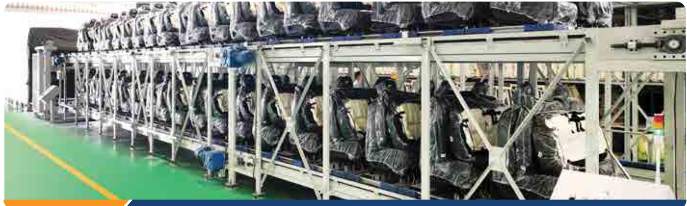
Băng chuyền vận chuyển ghế thành phẩm Finished chair conveyor belt
