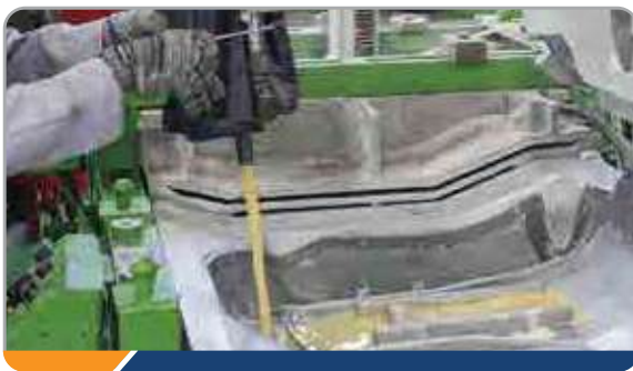
Công đoạn đổ hóa chất vào khuôn Pour chemicals into the mold
