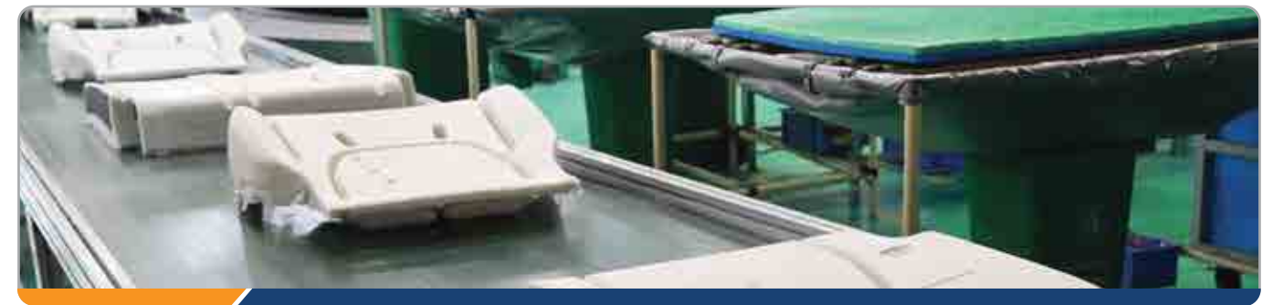
Nệm sau khi ép và hút chân không PU padding after pressing and vacuuming
