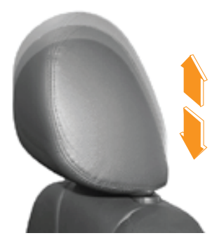
Điều chỉnh độ cao tựa đầu Height Adjustment of Head Restraint
