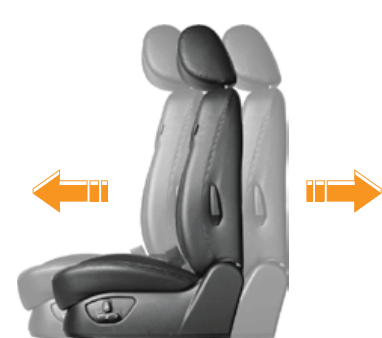
Điều chỉnh trượt ghế Seat Slide Adjustment
