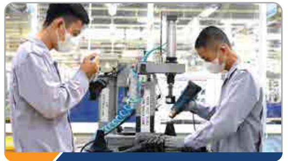
Lắp ráp chi tiết nhựa vào bọc cần số Assemble the plastic button into the gear knob cover
