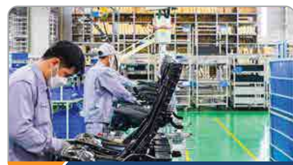
Lắp ráp khung xương Seat frame assembly
