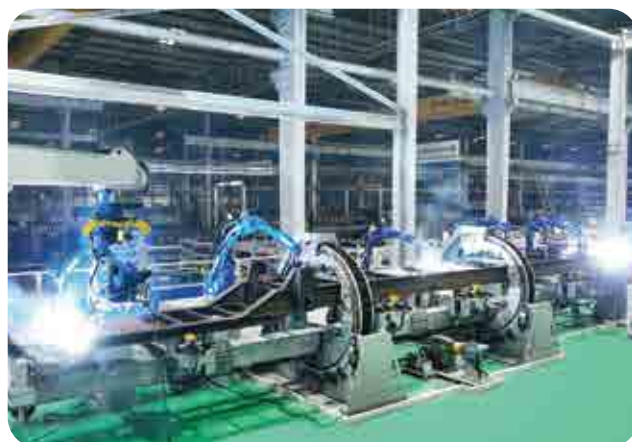
ROBOT HÀN TỰ ĐỘNG Chiều dài làm việc: 40.000 mm Số lượng: 40 robot
