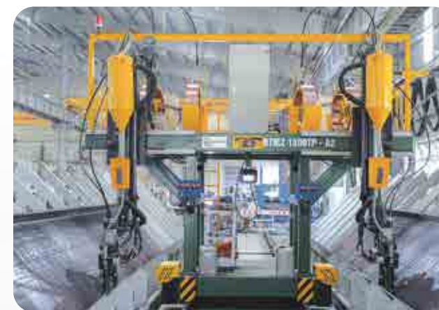
MÁY HÀN CỒNG Độ dày phôi: 6 - 80 mm Tốc độ hàn: 200 - 1.500 mm/phút
