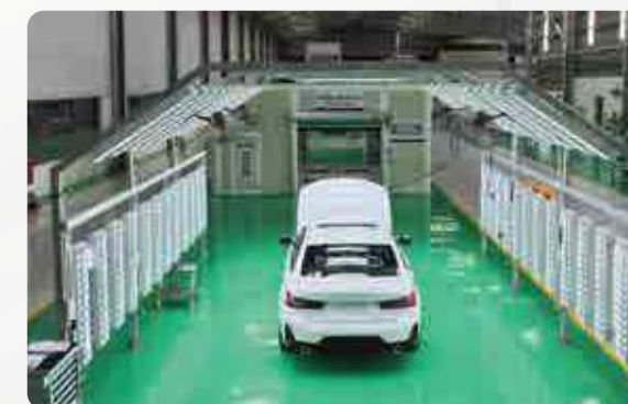
Trạm kiểm tra chất lượng hoàn thiện
