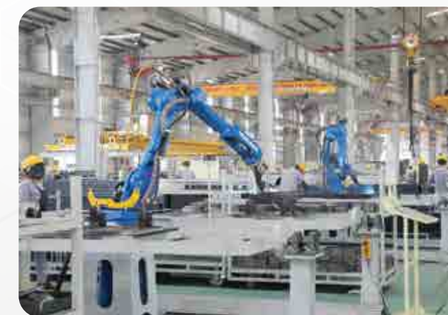
DÂY CHUYỀN ROBOT HÀN Tải trọng tối đa: 12 kg Độ chính xác: \pm 0,03 mm
