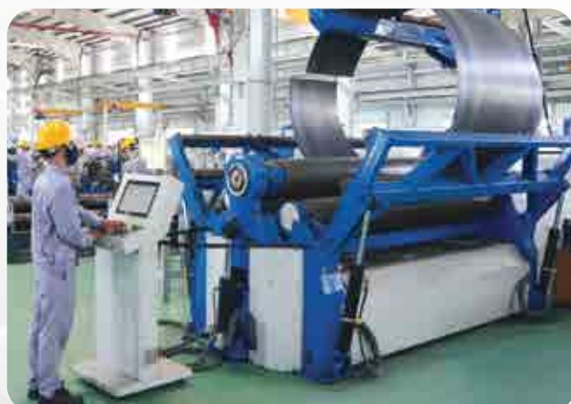
MÁY LỐC CNC 4 TRỤC Độ dày tối đa: 13 mm
