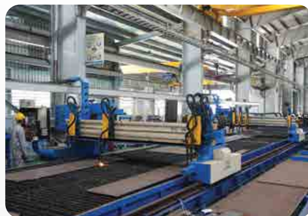
MÁY CẮT CNC OXY GAS VÀ PLASMA Độ dày phôi tối đa: 150 mm Kích thước cắt: 15.000 - 3.200 mm
