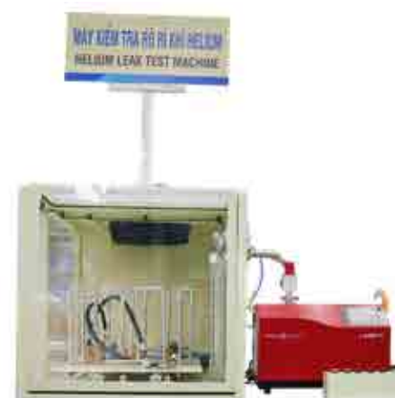
THIẾT BỊ KIỂM TRA RÒ RỈ KHÍ HELI HELIUM LEAK TESTING MACHINE
