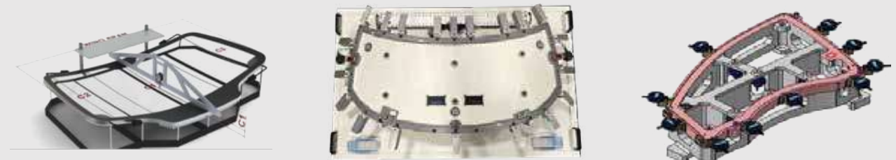
Thiết kế và sản xuất khuôn uốn và dướng kiểm tra kính Design and process glass bending mold, glass inspection jig
