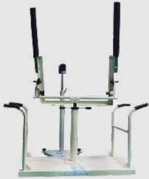
Thiết bị đo độ phân tách hình ảnh thứ cấp Secondary image tester
