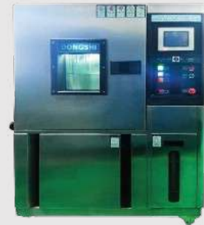
Thiết bị thử độ bền chịu ẩm & nhiệt độ cao High temperature & humidity tester
