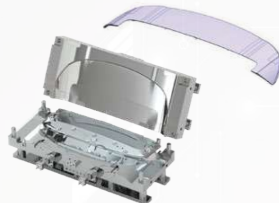
Khuôn thổi chi tiết lưới gió đuôi xe du lịch 01 Extrusion blow mold for spoiler passenger car
