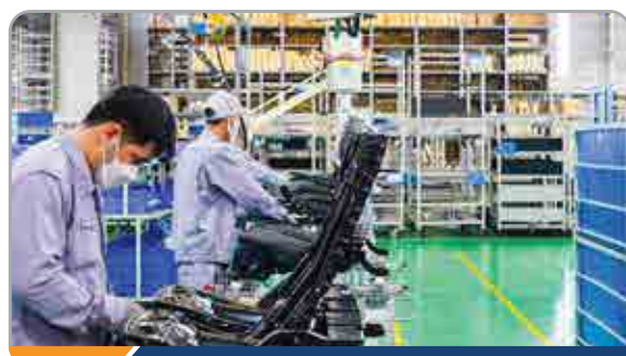
Lắp ráp khung xương Seat frame assembly
