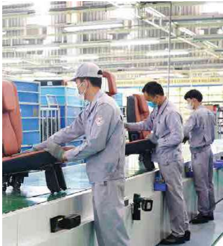
Lắp ráp ghế Seat assembly
