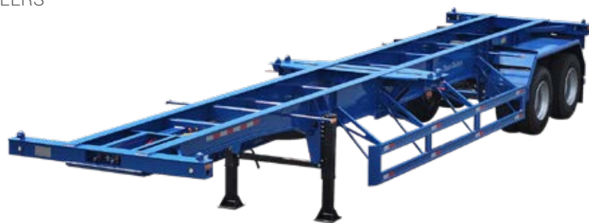
Sơ mi rơ moóc xương 2 trục 40' 8 khóa 40' Skeletal Tandem, 8 Twist Locks
