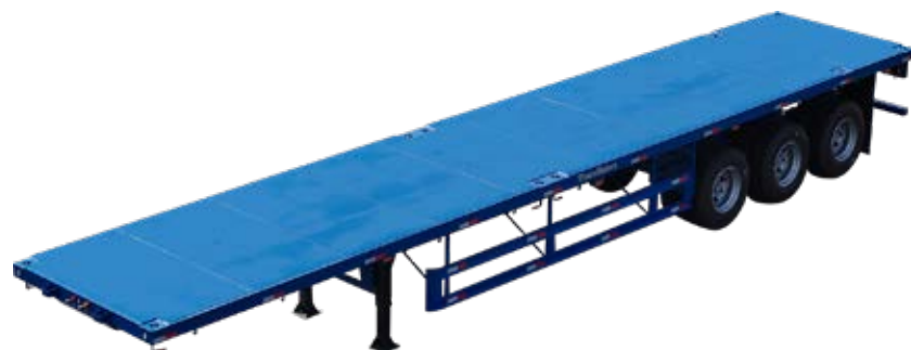
Sơ mi rơ moóc sàn 3 trục 45' 10 khóa 45' Flatbed Tridem, 10 Twist Locks
