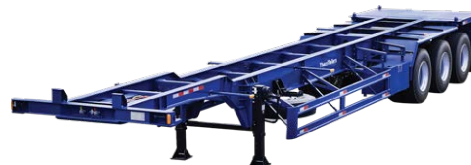
Sơ mi rơ moóc xương cổ cò 3 trục 45' 6 khóa 45' Skeletal Gooseneck Tandem, 6 Twist Locks
