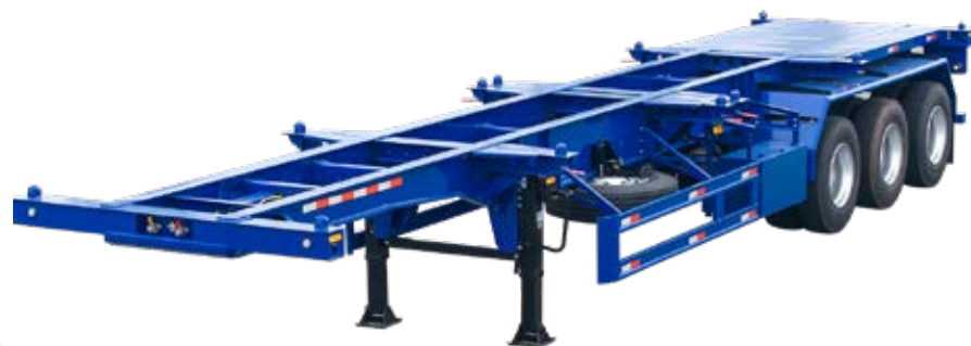
Sơ mi rơ moóc xương 3 trục 40' 12 khóa 40' Skeletal Tridem, 12 Twist Locks
