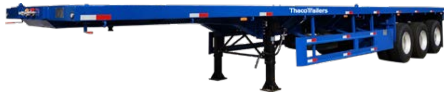
Sơ mi rơ moóc sàn 3 trục 40' 8 khóa 40' Flatbed Tridem, 8 Twist Locks
