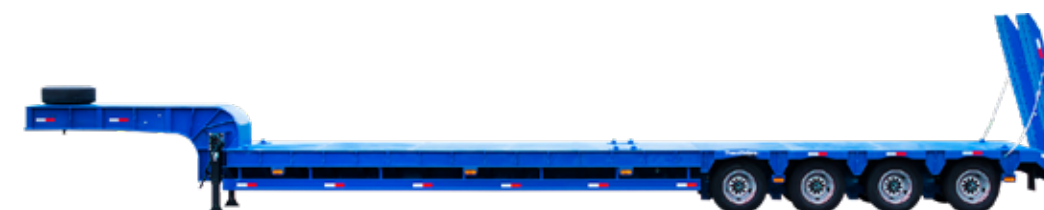
Sơ mi rơ moóc chuyên dụng chở xe, máy chuyên dùng hoặc container FR (4 trục) Quad-axle drop deck
