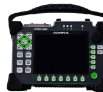
Máy siêu âm khuyết tật mối hàn Ultrasonic welding testing machine
