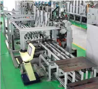
01 CÔNG ĐOẠN TẠO PHÔI MAKING WORKPIECE PROCESS
