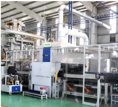
04 CÔNG ĐOẠN SƠN NHÚNG DIPPING PAINT PROCESS
