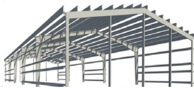
Kết cấu thép nhà xưởng
