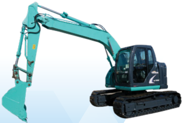
Xe đào bánh xích Kobelco
