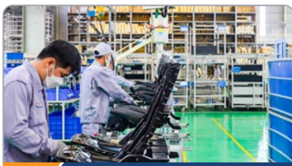
Lắp ráp khung xương Seat frame assembly
