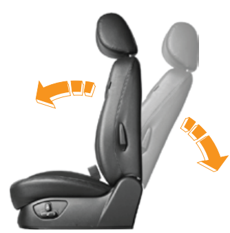
Điều chỉnh độ ngả Seatback Reclining Adjustment
