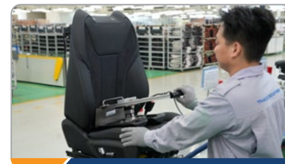
Kiểm tra cảm biến ngồi trên ghế xe BMW Sensor sitting check on the BMW seat
