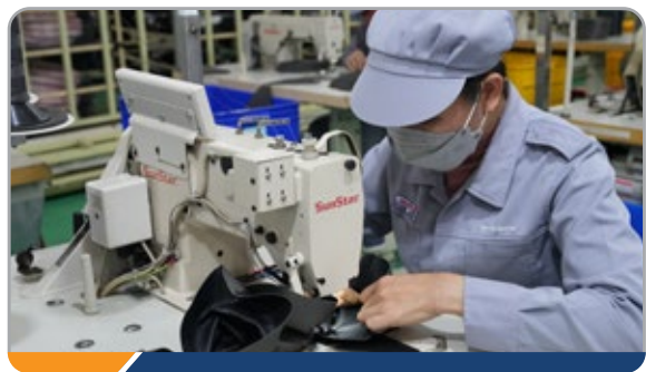
Máy điều các chi tiết vỏ bọc cần số Double stitch sewing
