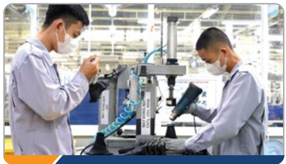
Lắp ráp chi tiết nhựa vào bọc cần số Assemble the plastic button into the gear knob cover
