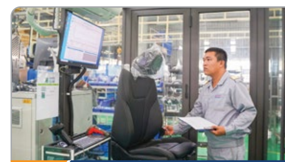
Kiểm tra tiếng ồn ghế BMW BMW seat noise test
