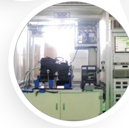
Kiểm tra chức năng EOL tester machine
