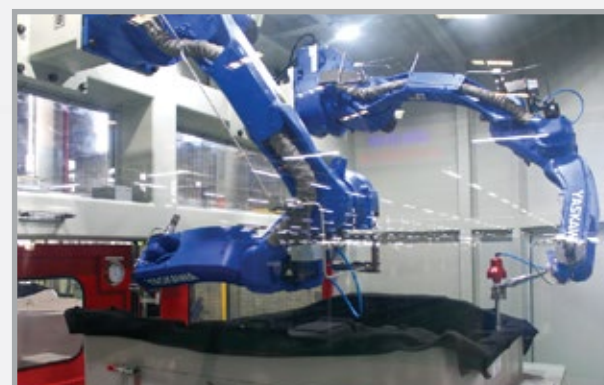
Robot cắt nước thực hiện công đoạn cắt Water-cutting robot performs the cutting operation
