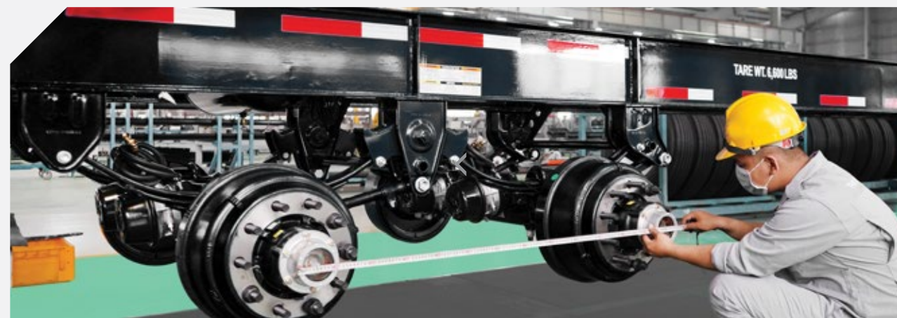
5 Điều chỉnh và lắp ráp trục cầu
