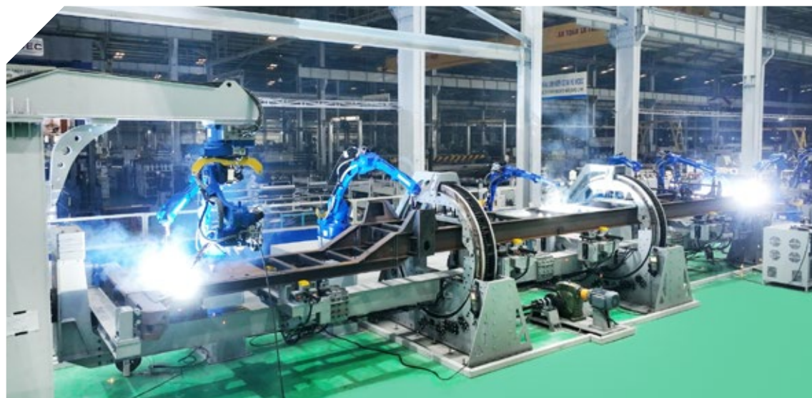
DÂY CHUYỀN HÀN LIÊN KẾT BẰNG ROBOT Nhà sản xuất: Miller (Mỹ) Chiều dài: 40.000 mm
