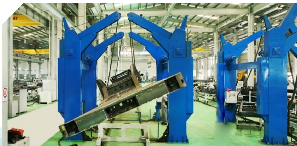
THIẾT BỊ XOAY SƠ MI RÔ MOỐC Tải trọng tối đa: 10 tấn Kích thước (LxWxH): 6.000 x 4.100 x 5.000 mm
