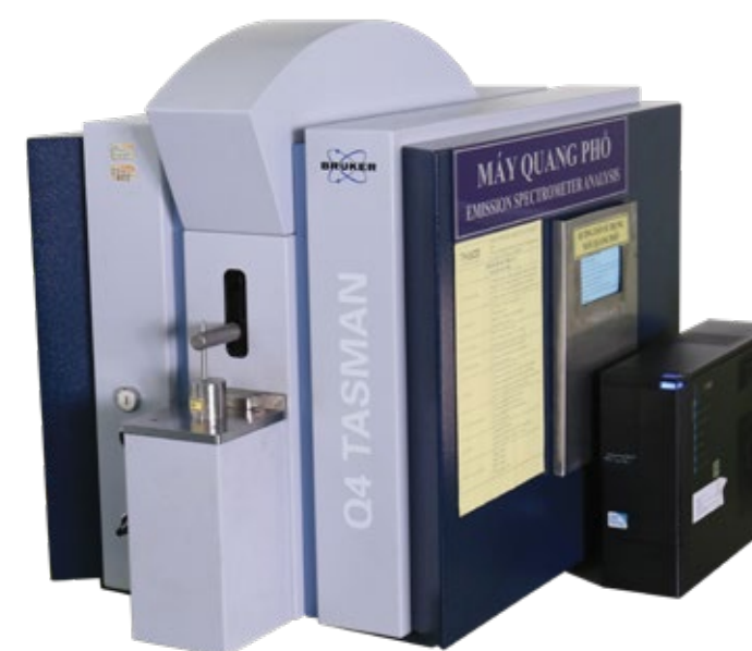
Máy quang phổ (kiểm tra thành phần vật liệu)
