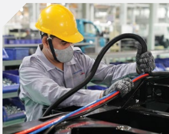
2 Lắp ráp hệ thống điện
