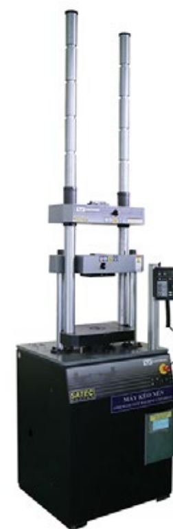
Máy kéo nén (kiểm tra tính cơ lý của vật liệu)
