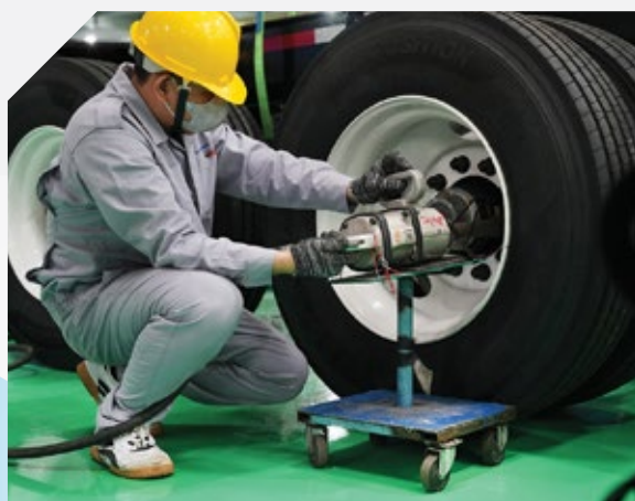
7 Lắp ráp bánh xe
