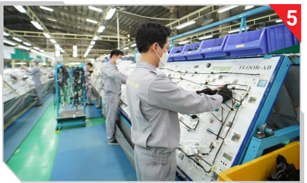
Kiểm tra trực quan Visual Inspection
