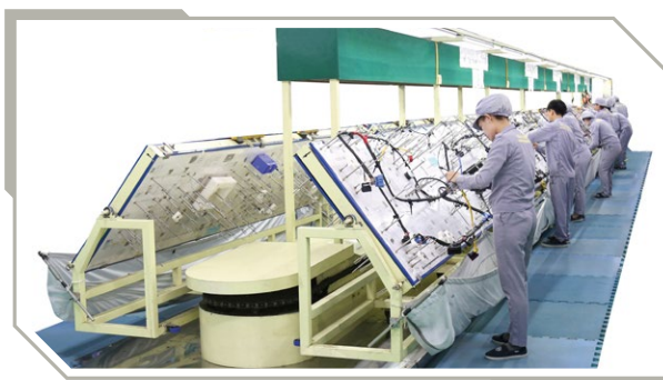
Băng chuyền lắp ráp Conveyor Năng suất trung bình: 12 bộ/ giờ Capacity: 12 Pcs/ hour
