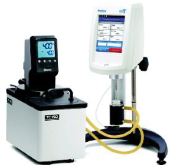
Máy đo độ nhớt Brookfield Brookfield Viscometers
