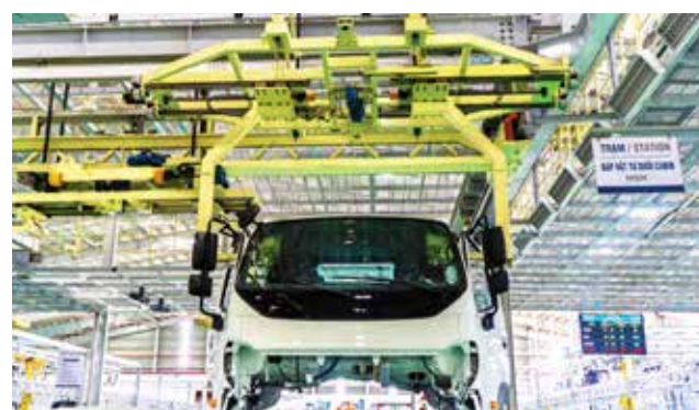
Hệ thống EMS Electric monorail system
