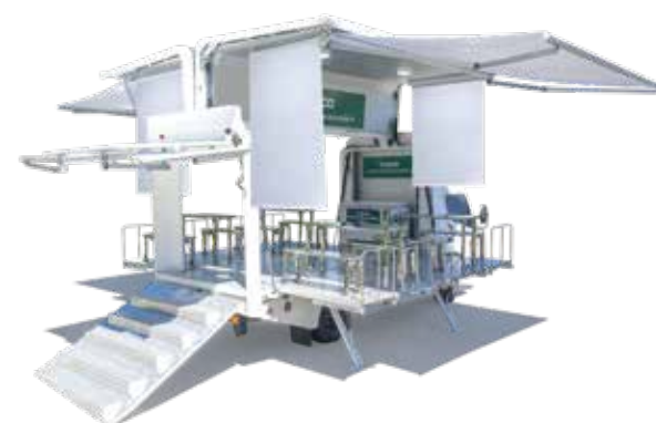
Thùng xe chuyên dụng phục vụ tiêm chủng vaccine Specialized truck body for mobile vaccination
