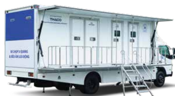
Thùng xe chuyên dụng y tế chụp X-quang và siêu âm Specialized medical truck body for X-ray and ultrasound
