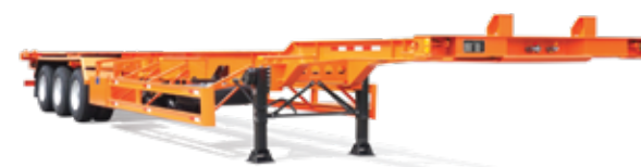
Cổ ngỗng 48', 3 trục, 6 khóa gù 48' Gooseneck, 3 axles, 6 twist locks
