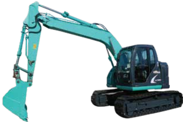
Xe đào bánh xích Kobelco
