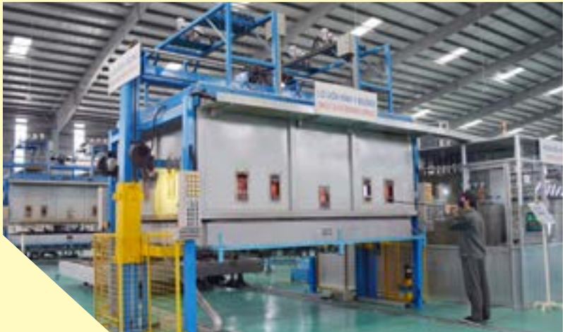
LÒ UỐN KÍNH 01 BUỒNG/ SINGLE BENDING FURNANCE Kích thước/ Dimension: Max 2.000x3.000mm Hiệu suất/ Performance: 98% Chu kỳ uốn/ Circle time: 96 phút/bộ
