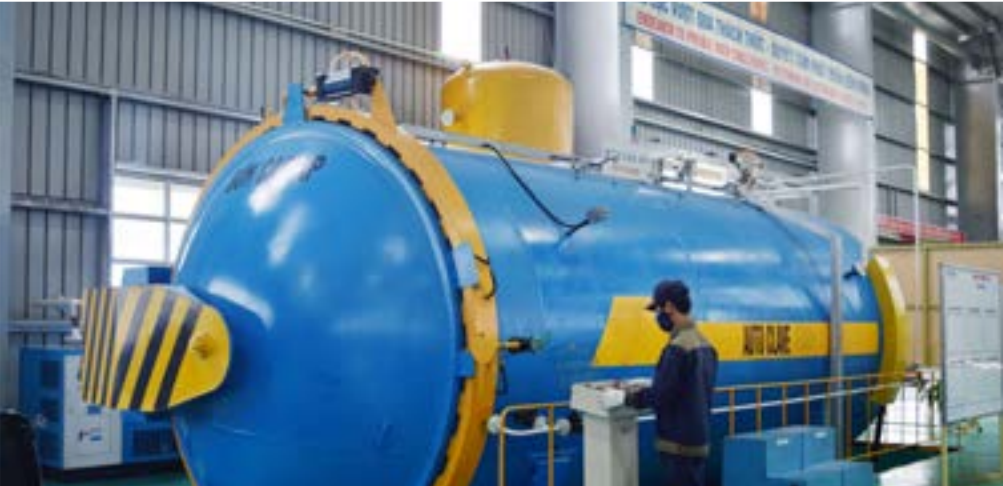
BỒN CAO ÁP/ AUTOCLAVE Áp suất/ Pressure: 1.3 Mpa Nhiệt độ làm việc/ Temperature : 135°C
