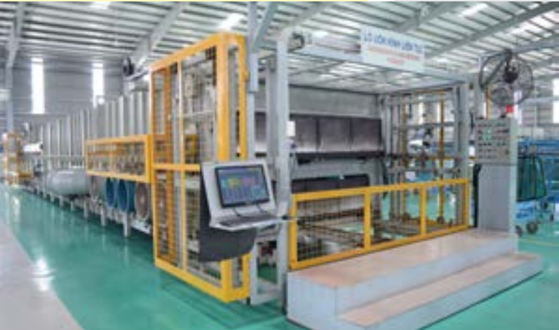
LÒ UỐN KÍNH LIÊN TỤC / CONTINUOUS BENDING FURNACE Kích thước/ Dimension: Max 1.100x2.400mm Chu kỳ uốn/ Circle time: 100÷140 giây/lần
