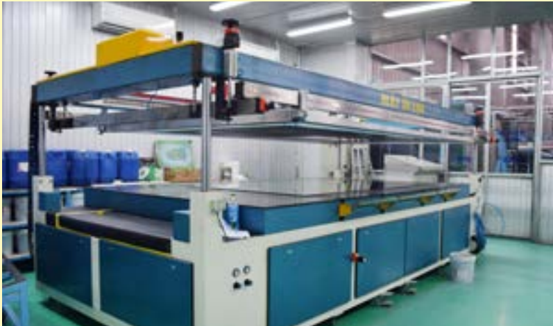
MÁY IN LỤA/ SILK PRINTING MACHINE Công suất/ Capacity: 200 products/ day Hệ thống điều khiển/ Controlling system: PLC
