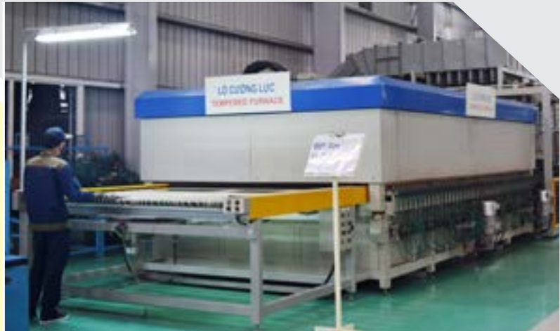
LÒ CƯỜNG LỰC 2D/ 2D GLASS TEMPERING FURNACE Kích thước/ Dimension : Max 2.200x1.500mm Độ dày kính/ Thickness of glass: 3,5÷6mm
