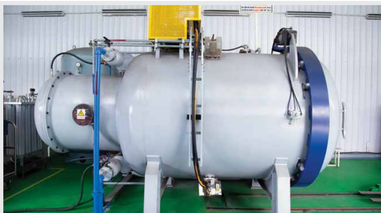
LÒ NHIỆT LUYỆN CHÂN KHÔNG VACCUM HEAT TREATMENT
