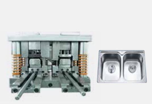
Khuôn dập chậu rửa inox Stainless steel sink Stamping Die
