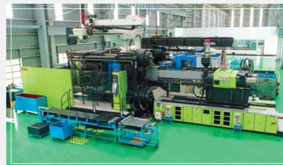
MÁY ÉP PHUN NHỰA INJECTION MACHINE
