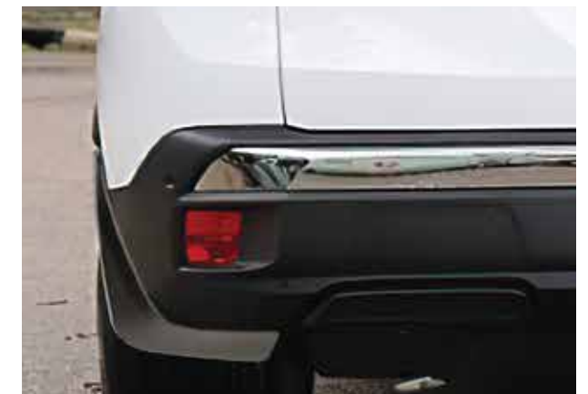
Sau khi lắp chắn bùn After installing
