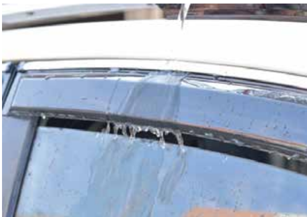
Ngăn mưa và tạo khoảng hở với kính xe, đảm bảo tầm nhìn Preventing waterdrop and creating gap with glasses, ensuring visibility
